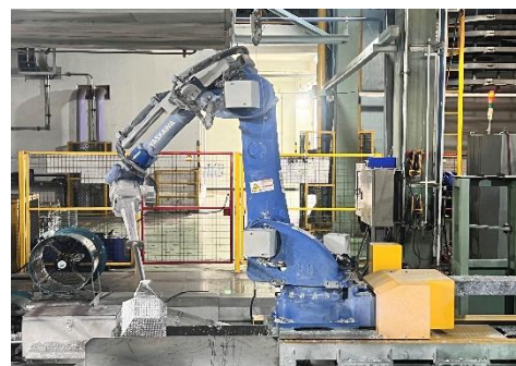
รูปที่ 3.2-52 หุ่นยนต์ทำงานในบริเวณ ที่มีอุณหภูมิสูงและแสงจ้า
