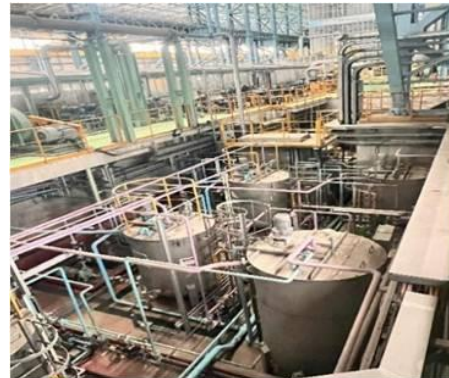
รูปที่ 3.2-8 บ่อรวบรวมสารละลายโครเมียม จากกระบวนการเคลือบผิว
